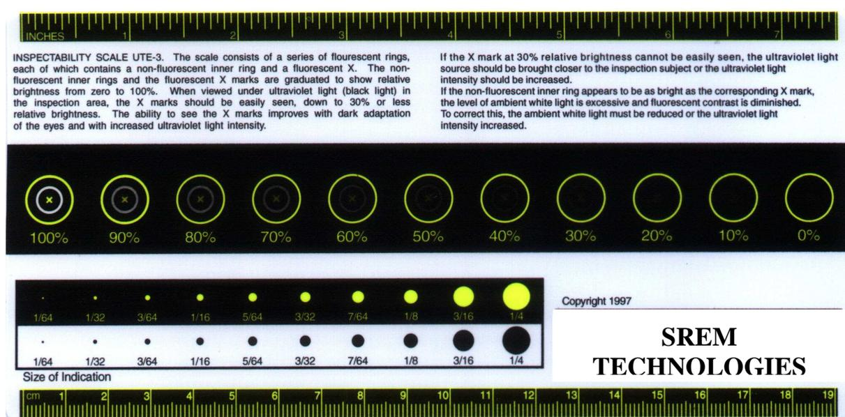
L'échelle UTE-3 d'adaptation visuelle pour examen sous rayonnement ultraviolet (UV-A) permet de déterminer si la brillance fluorescente des indications à la surface examinée est suffisante, et si elle offre un contraste convenable avec la lumière blanche parasite ambiante. Elle permet également de savoir si la vue du contrôleur s'est suffisamment adaptée pour distinguer les indications de dimensions qu'il recherche.
